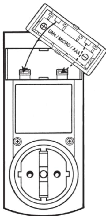
beim Schließen des Batteriefachs bitte unbedingt darauf, dass die beiden Kontakte am Deckel in die Kontakte der Zeitschaltuhr gelangen. Nachdem Sie das Fach wiedergeschlossen haben, drücken Sie bitte einmal kurz mit einem spitzen Gegenstand, z.B. einem Kugelschreiber, auf die Rückstell-Taste auf der Vorderseite der Uhr. Nach einem kurzen Aufleuchten aller Display-Elemente stellt sich die Uhr automatisch auf Montag, 00.00 Uhr, OFF, ~~☒~~ .
