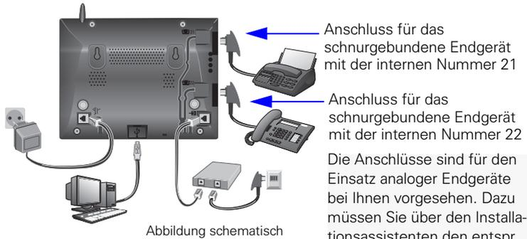
↖ Anschluss für das schnurgebundene Endgerät mit der internen Nummer 21
